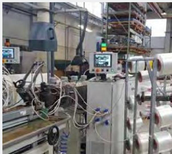
I **profili rinforzati** Ag sono realizzati in pvc flessibile rinforzato con fili di poliestere. Questa caratteristica li rende molto resistenti alla trazione e durevoli nel tempo .
